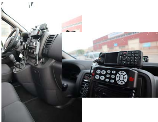
Cuadro de mandos y detalle del mando del puente
